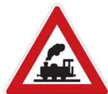
A 30 Železniční přejezd bez závor
