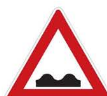
A 7a Nerovnost vozovky
