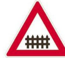
A 29 Železniční přejezd se závorami
