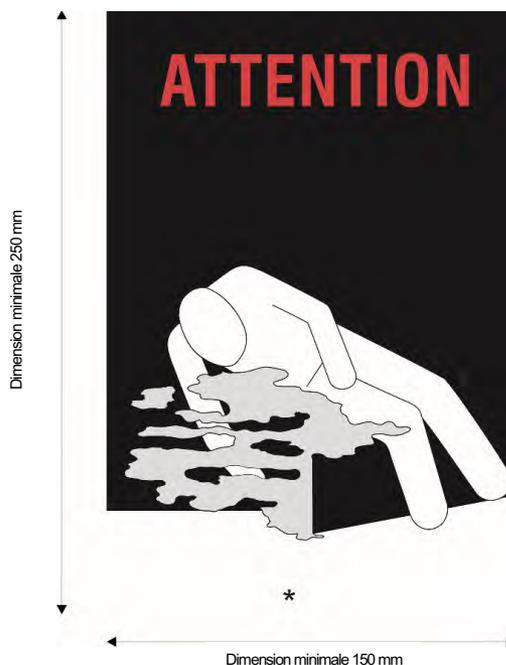
Marque de mise en garde pour le refroidissement ou le conditionnement des véhicules et conteneurs
