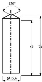
Fig.2: Piston cylindrique en bronze, dimensions en mm
