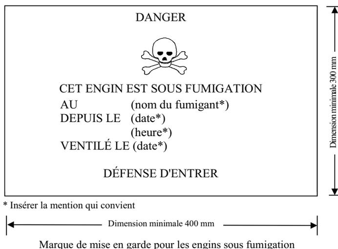
La marque doit avoir une forme rectangulaire et mesurer au moins 400 mm de large et 300 mm de haut. L'épaisseur minimale de la ligne extérieure doit être de 2 mm. La marque doit être de couleur noire sur fond blanc et les lettres doivent mesurer au moins 25 mm de hauteur. Lorsque les dimensions ne sont pas spécifiées, tous les éléments doivent respecter approximativement les proportions représentées ci-dessus.
