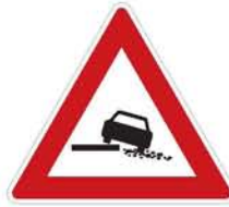
A 28 Nebezpečná krajnice
