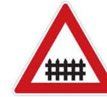
A 29 Železniční přejezd se závorami
