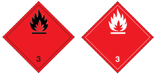
(Nr. 3) Symbol (Flamme): schwarz oder weiß auf rotem Grund; Ziffer «3» in der unteren Ecke
