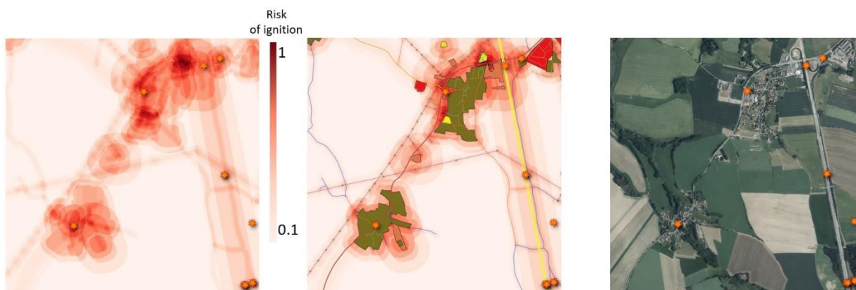
Obr. 62. Zvětšený fragment vrstvy „Riziko nebezpečí požárů“ (vlevo a střed) a místa skutečných požárů (oranžové body, vpravo).
