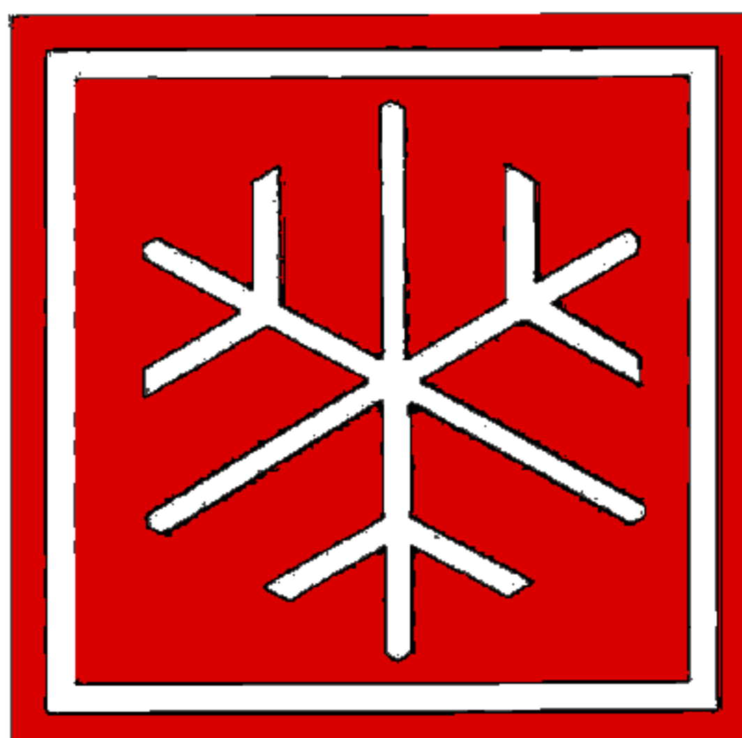
h) Plynové hasicí zařízení
