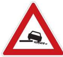
A 28 Nebezpečná krajnice
