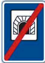
IP 8b Konec tunelu
