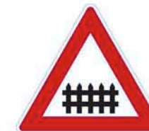
A 29 Železniční přejezd se závorami
