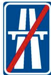
IP 14b Konec dálnice
