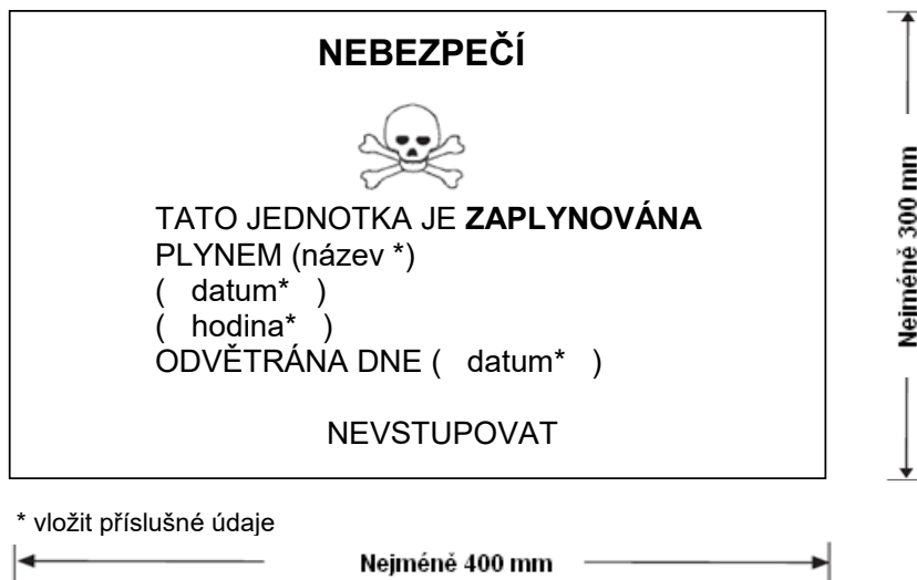
Výstražná značka pro zaplynovanou jednotku
