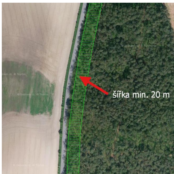
Obr. 19: Příklad umístění ochranného protipožárního pláště u silnice I. třídy v borovém porostu.
